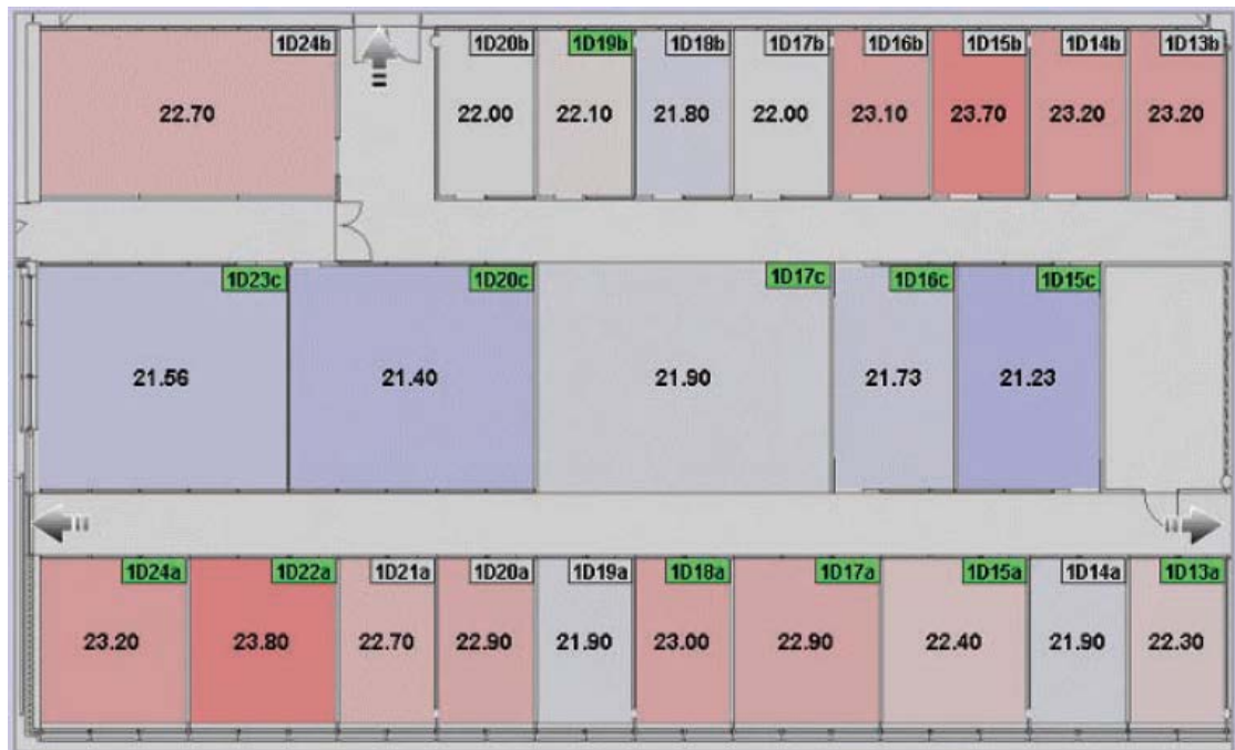
KUVIO 1. Valvomonäkymä rakennuksen pohjakaaviosta (Sahlstén 2010, 13)
