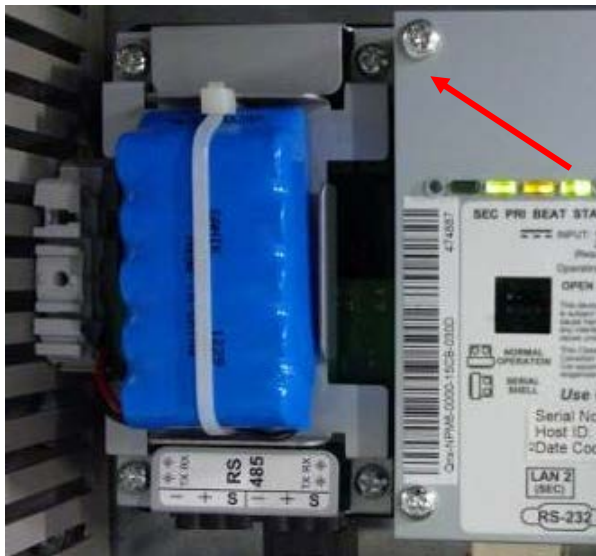
KUVIO 4. Hawk paristopakettin irrottaminen
