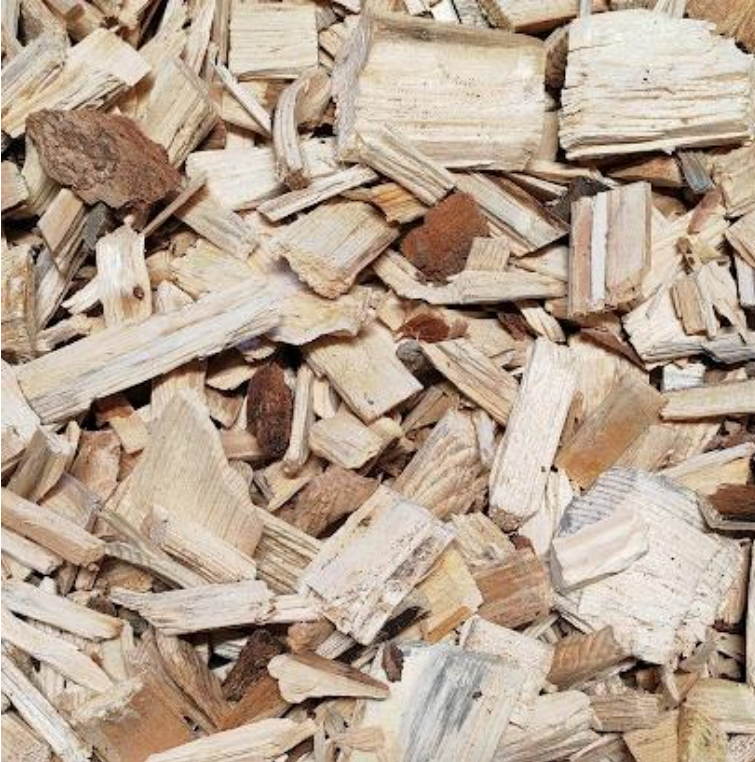
KUVA 5. Walter-voimalaitoksen polttoaineena käytetty puuhake
