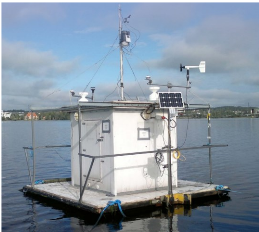
Kuva 6. Vedenlaadun jatkuva-toiminen mittausasema (SYKE 2018, 17.)
