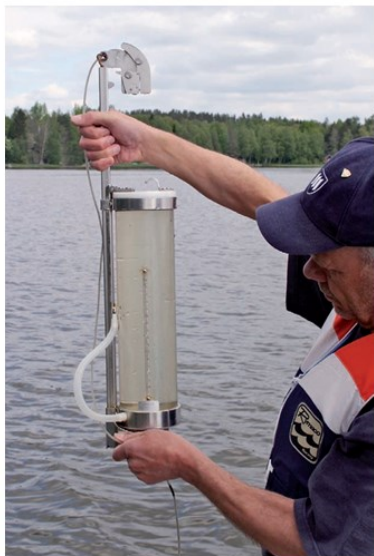
Kuva 3. Lämpötila tarkastetaan heti näytteenottimen noustua vedestä (Kettunen ym. 2008, 45.)
