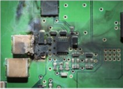
KUVA 1. ESD:n aiheuttama fataalivika piirilevyllä (Barcode Factory 2023.)
