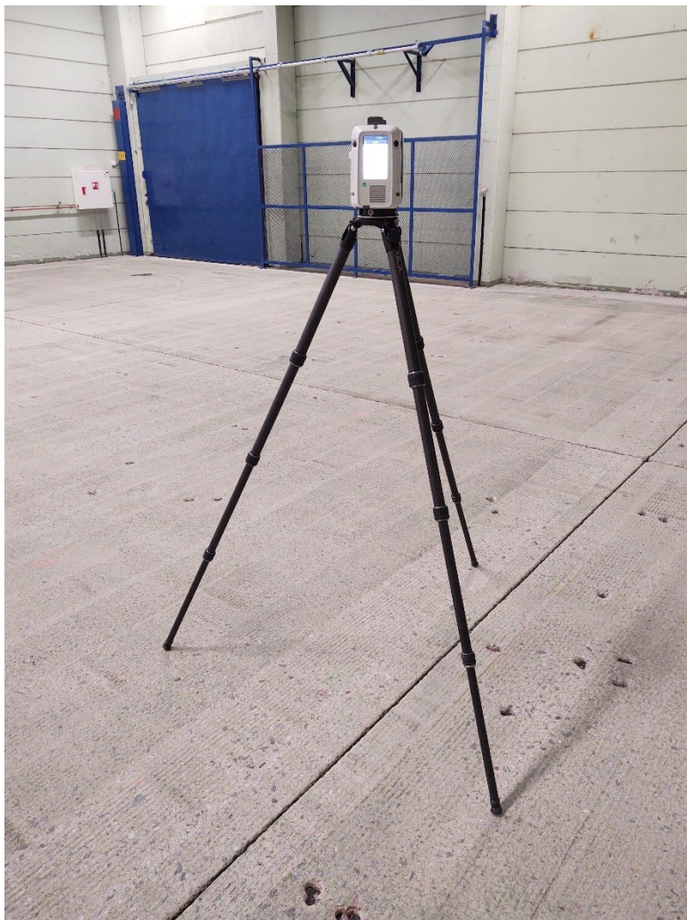
Kuva 7. Leica RTC360 laserkeilain
