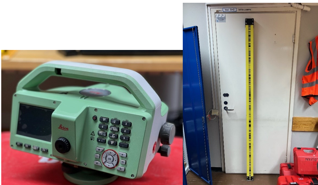
Kuva 9 Tarkkavaaituskoje ja invarlatta (6.)
