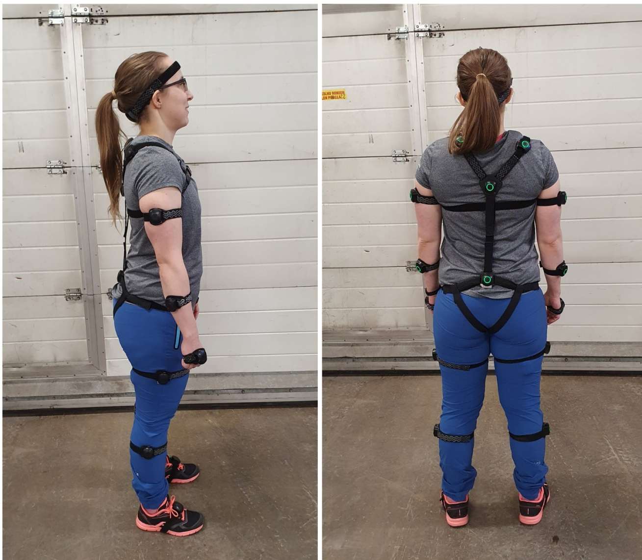
Kuva 2. Liikkeenkaappausjärjestelmän IMU-anturit kiinnitettynä. Toivonen, 2023.
