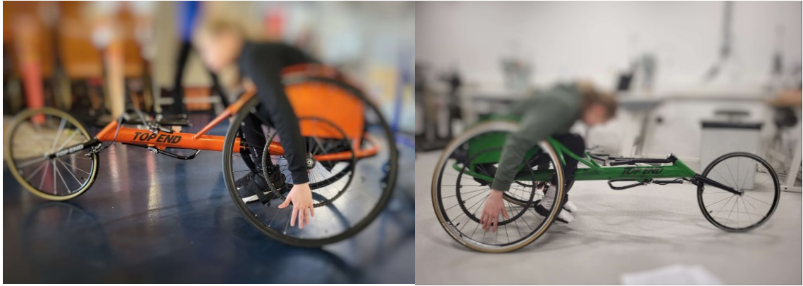
Kuva 20. Mittatilaustuolissa (vas.) harrastajan sormet ylettyvät paremmin kelausvanteelle verrattuna lainatuoliin. (Korpi 2023)
