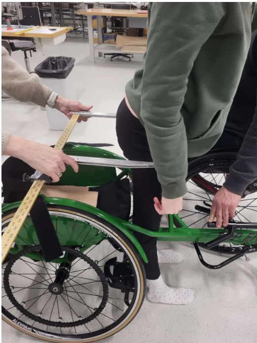
Kuva 5. Reiden pituuden mittausta korin syvyyden määrittämistä varten. (Korpi 2023)
