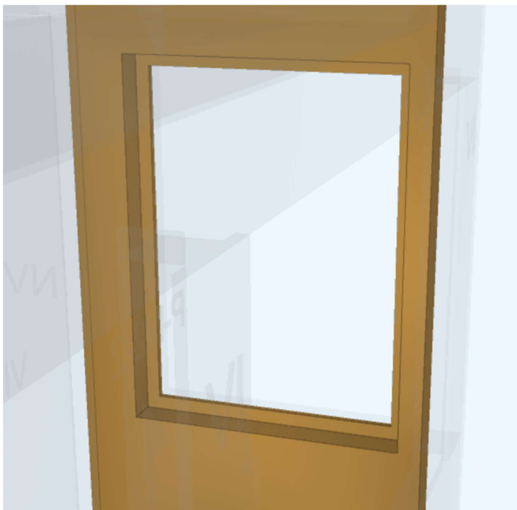
Kuva 25. IFC-malli ikkuna huulloksesta CLT-elementissä (Keskisalo, 2023a).
