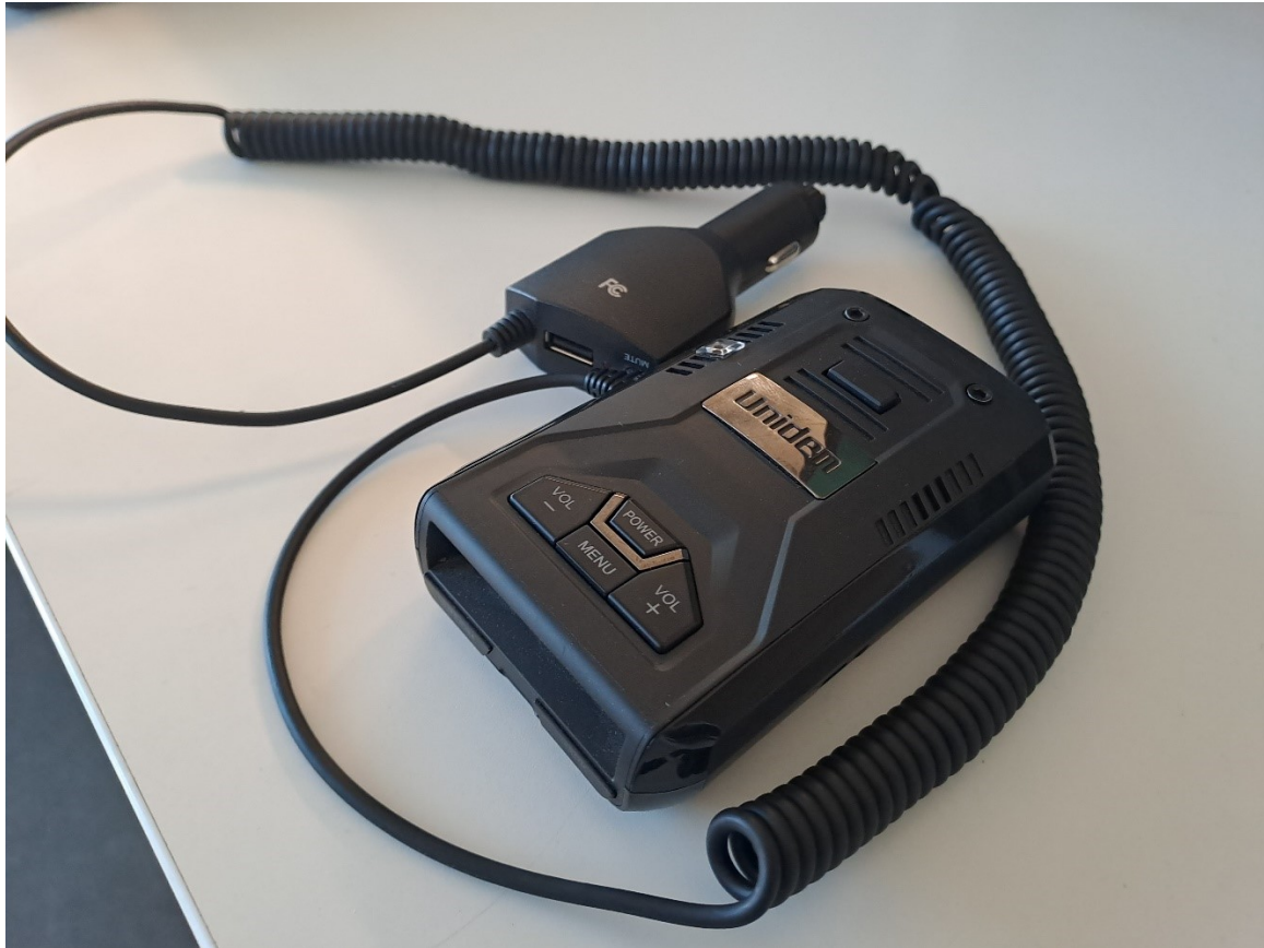
Kuva 2: Tutkanpaljastin Uniden R3 virtajohtoineen. (Kuva: Tuomo Seppä)
