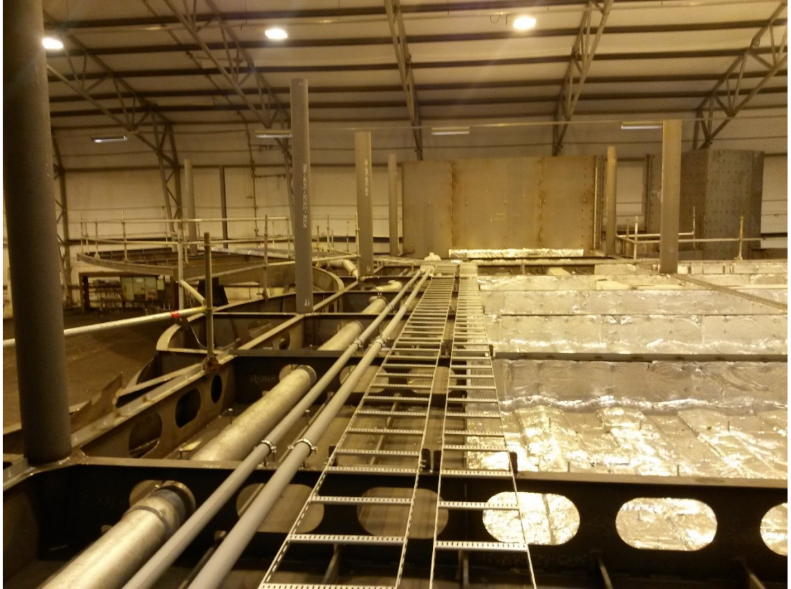
Kuva 2: Lohko EMV-vaiheessa varustelukatoksessa ylösalaisin.
