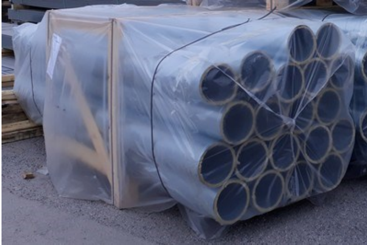
Kuva 5: Siisti spirokanavakehikko. (Meyer Turun telakka, 2019a43.)
