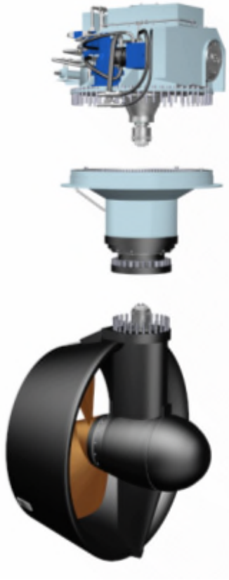
Kuva 18 AQM 225 Potkurilaitteen jako osakokonaisuuksiin: ylä-, väli- ja alaosa (Rolls-Royce Oy)
