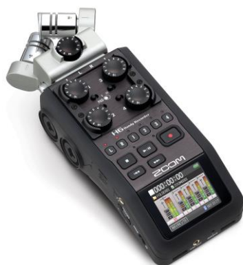
KUVA 35. Zoom H6 kenttätallennin XY-stereomikrofonin kanssa (Flint 2013).
