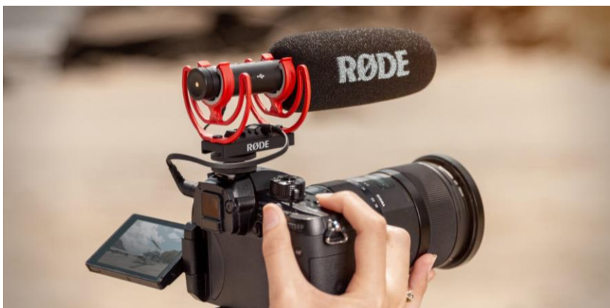
KUVA 34. Røde videomic NTG asennettuna järjestelmäkameran salamakenkään (von Voss 2019).
