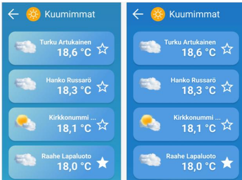
Kuva 4. Sääsovelluksen listanäkymä ennen (vas.) kontrastivaatimusten soveltamista ja sen jälkeen. Alustava Figma-suunnitelma.
