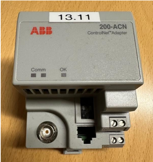
KUVA 7. Nykyisen järjestelmän ControlNet-adapteri
