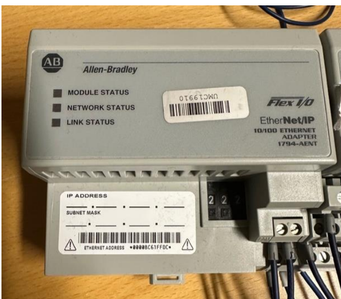
KUVA 9. Allen-Bradleyn vastaava Ethernet/IP-adapteri
