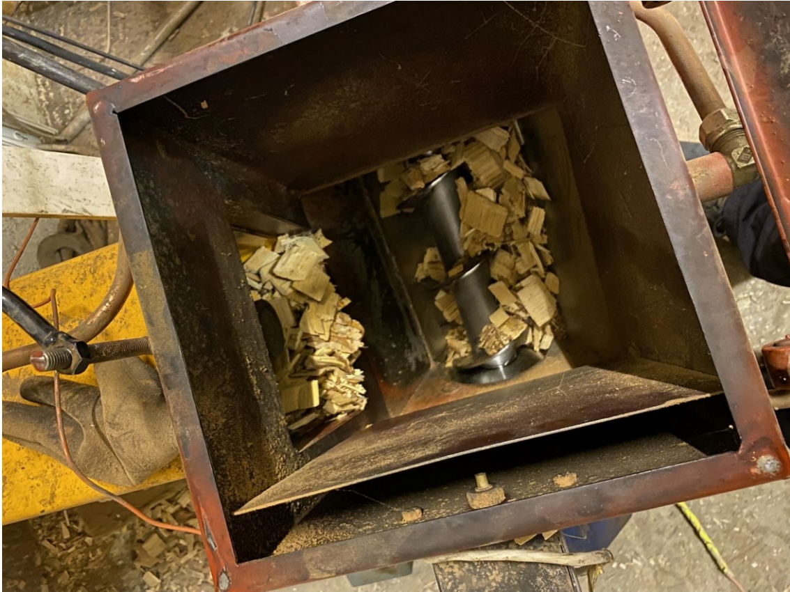
KUVA 16. Nousuruuvin kulmalaatikko ja ylitäytönestín
