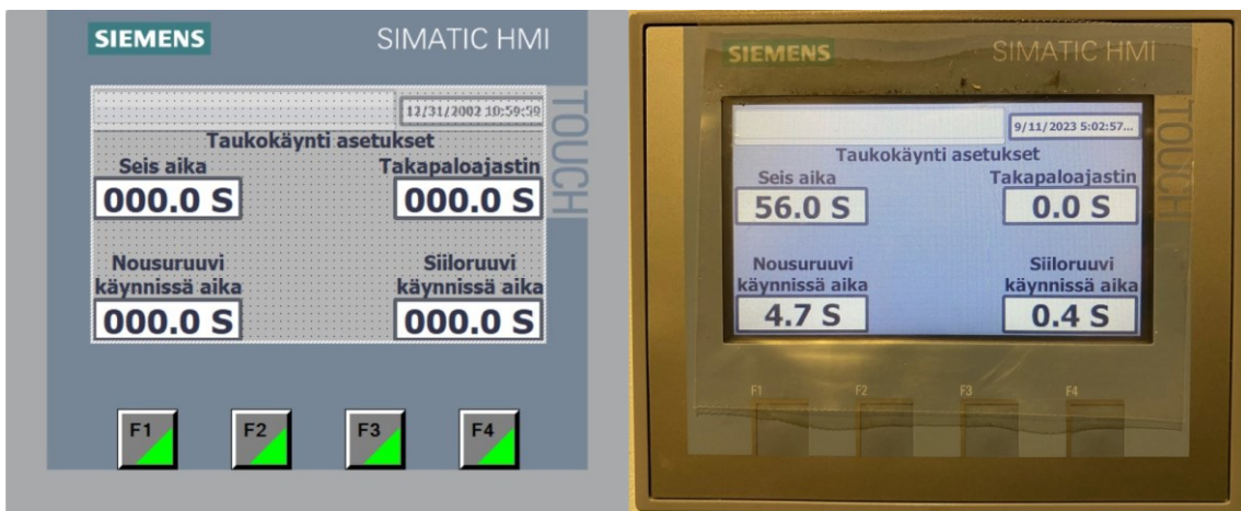
KUVA 41. Taukokäynnin asetusnäyttö TIA Portalissa ja kosketusnäytöllä
