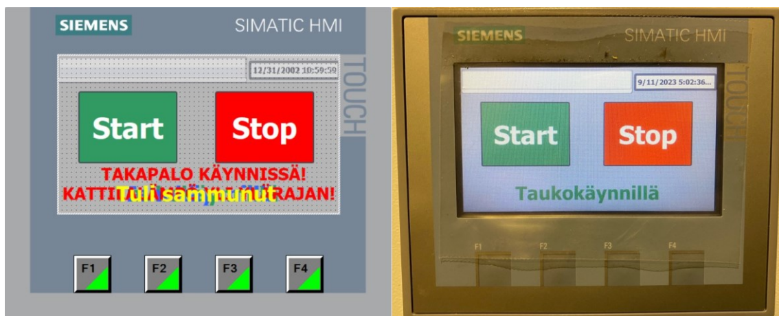
KUVA 37. Aloitusnäyttö TIA Portalissa ja kosketusnäytöllä
