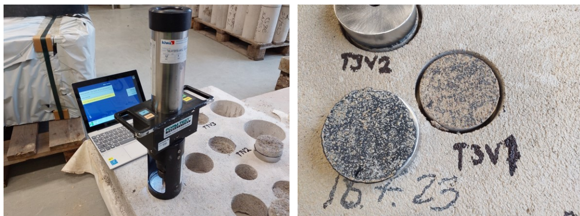
KUVA 38. Vasemmalla testauslaitteisto ja oikealla testipisteet sekä epoksilla liimatut vetokappaleet (Korolainen 2023, CC BY-SA).
