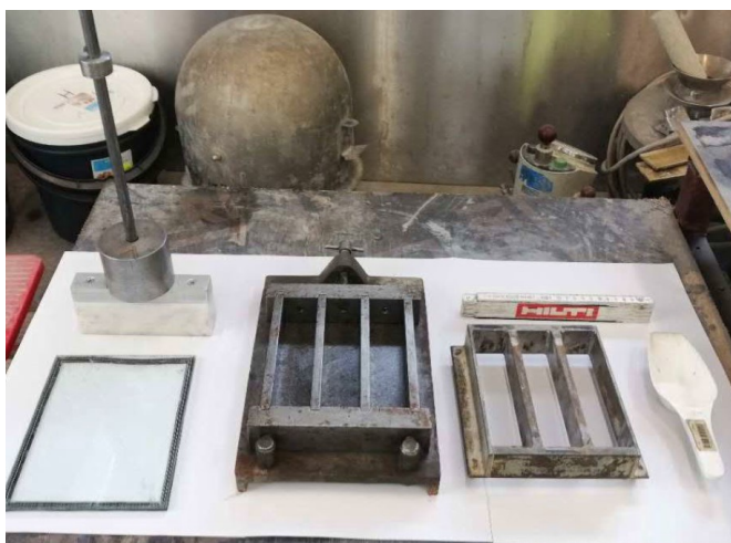
KUVA 33. Maakostean betonimassan velvoittavien ominaisuuksien tutkimiseen voidaan käyttää niin sanottua Prisma-mittausta (Komonen 2022).
