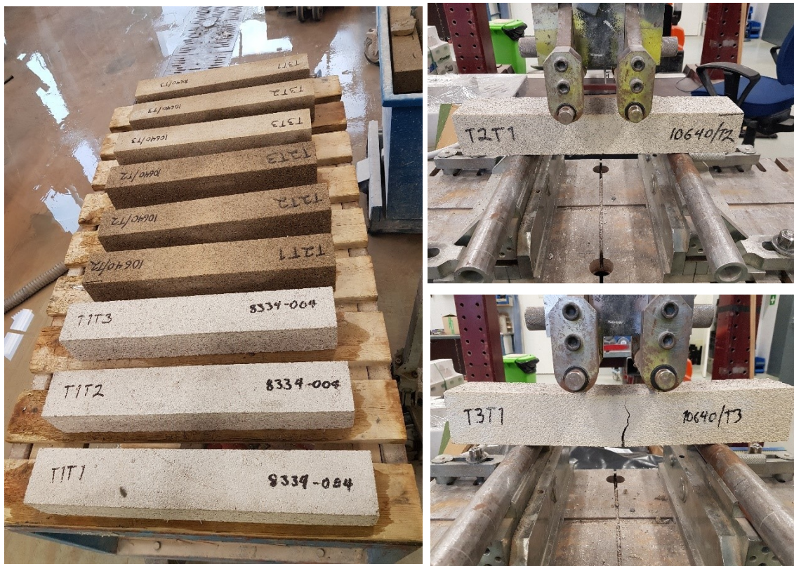
KUVA 37. Taivutusvetolujuuden testikappaleet ja taivutusvetokoejärjestelyt laboratoriossa (Korolainen 2023, CC BY-SA).
