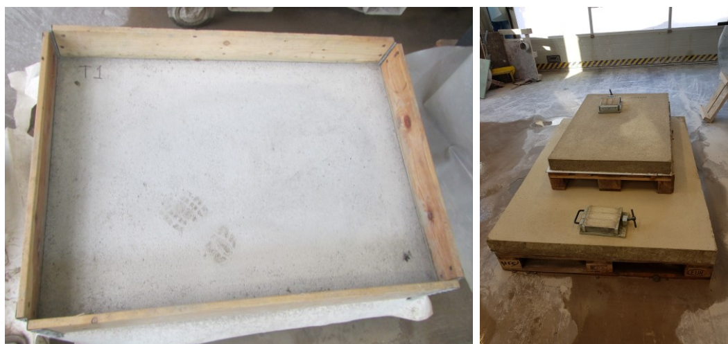
KUVA 34. Maakosteasta betonista valmistetut 1,2 m x 0,8 m ja 2,4 m x 1,6 m kokoiset koekappale-laatat (Korolainen 2023, CC BY-SA).
