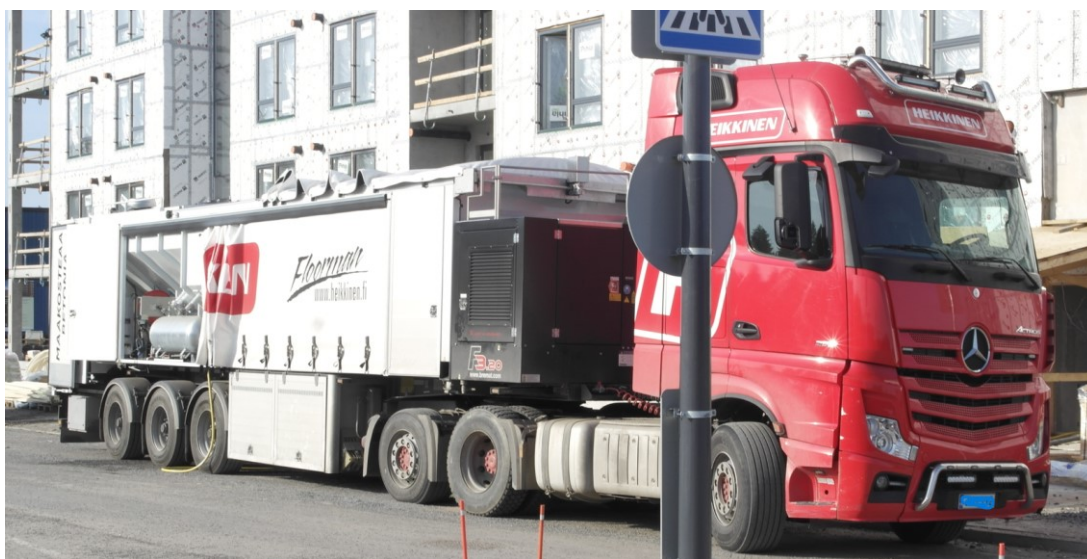
KUVA 1. Maakostean työmaabetonin sekoitinauto (Korolainen 2023, CC BY-SA)
