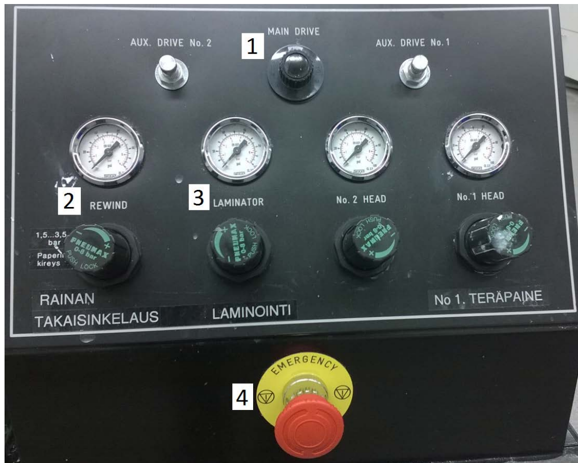
KUVA 10. Ohjauspöytä. 1. Nopeussäätö 2. Jarrun paine 3. Laminaattorin paine. 4. Häätä-seis -painike.
