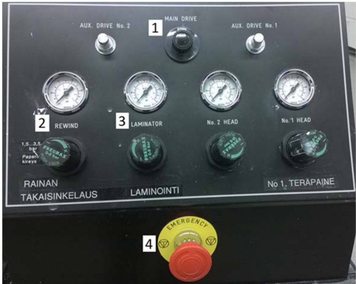
KUVA 3. Ohjauspöytä. 1. Nopeussäätö 2. Jarrun paine 3. Laminaattorin paine. 4. Häätäseis -painike.
