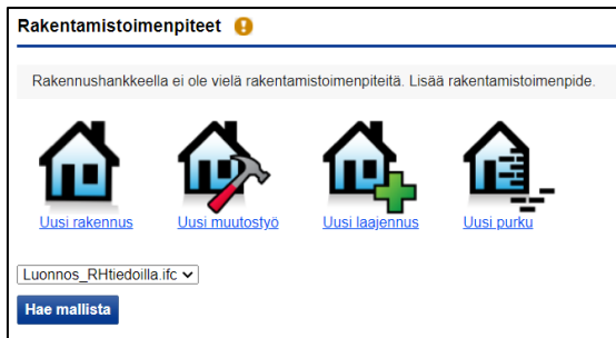
KUVA 42. Rakentamistoimenpiteen tyyppin hakeminen rakennusluvalle IFC-tietomallista
