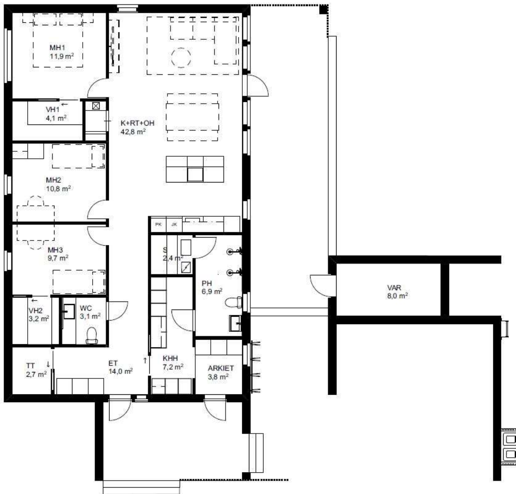
KUVA 19. ARKI 142 pohjapiirustus. 3 mh, k+rt+oh, 2xvh, wc, tt, et, khh, arkiet, ph, s
