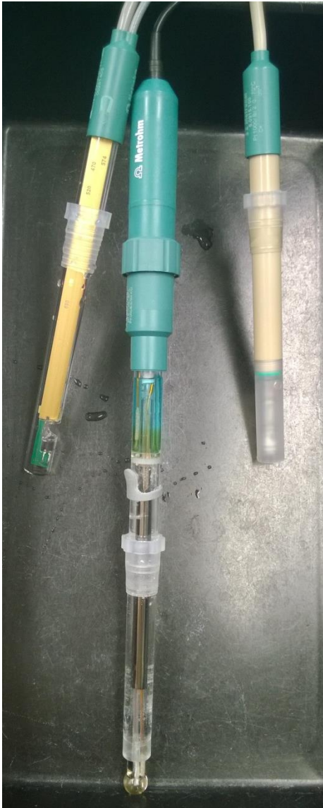
KUVA 5 Optrode (vas.), pH-elektrodi, sähkönjohtokykyanturi (oik.)
