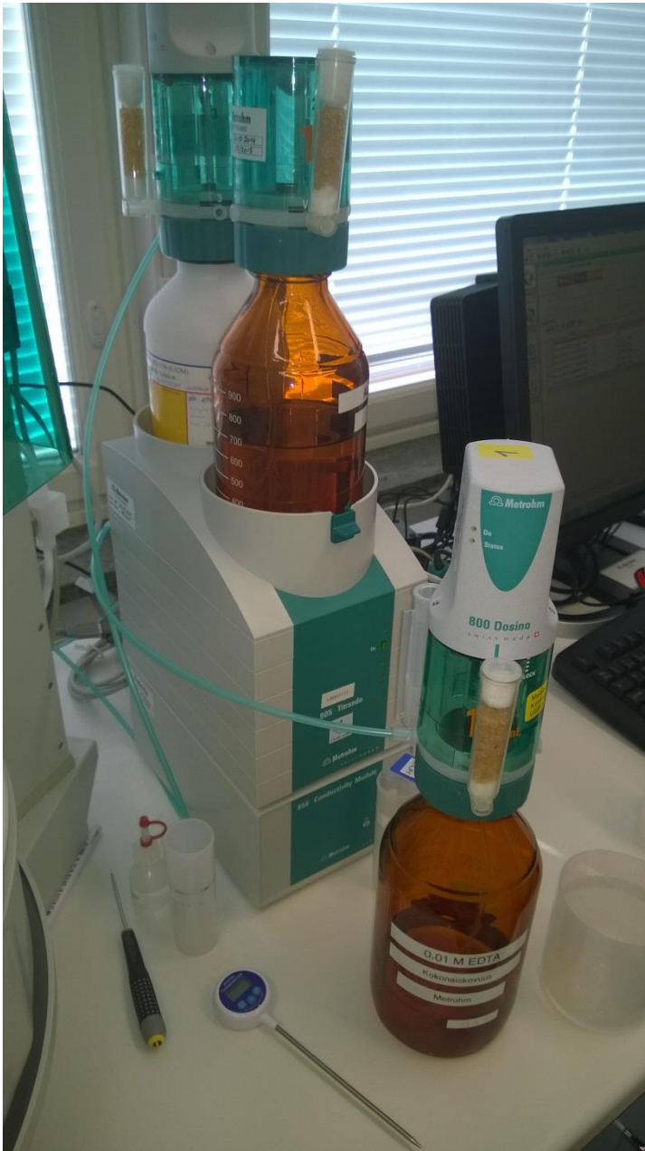
KUVA 4 Titrando, Conductivity Module, Dosino ja pulloja titranteille
