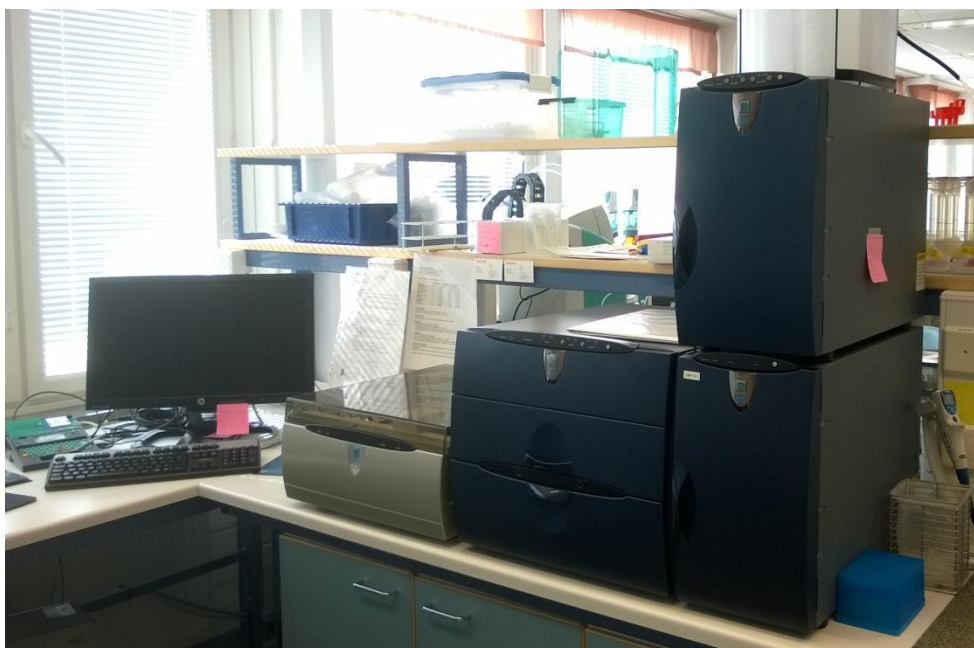
KUVA 10 Dionex ICS-5000 -ionikromatografi
