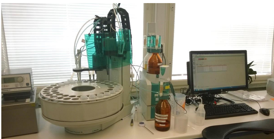
KUVA 3 Termостоitu vesihaude, monitoimititraattori ja tietokone
