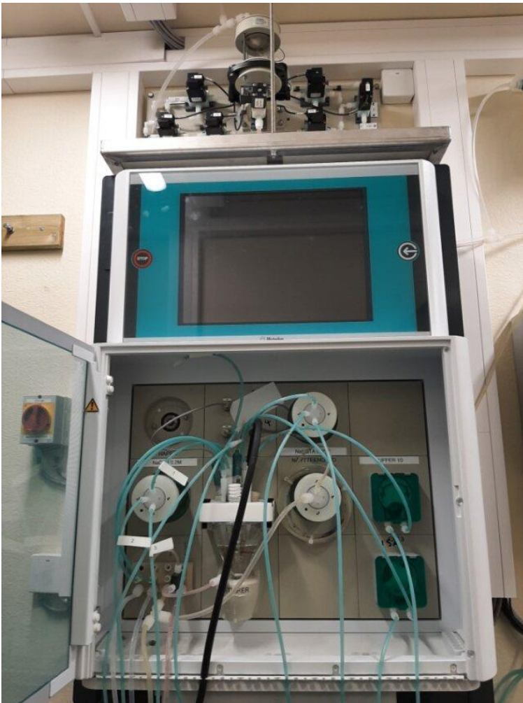
Kuva 7. OTI-titraattorin kosketusnäyttö ja kaappi
