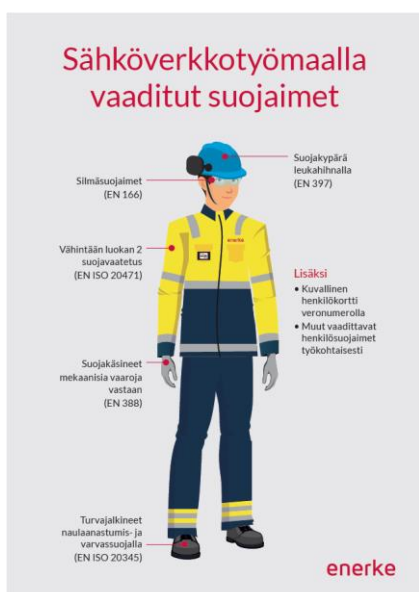
Kuva 1 Sähköverkkotyömaalla vaaditut suojaimet ja työasu (Kuva: Enerke Oy).
