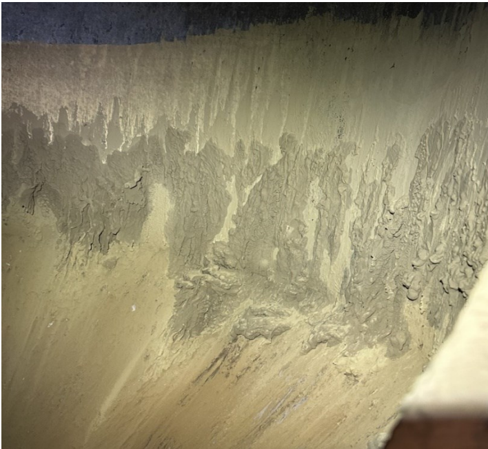
KUVA 3. Tuotetta kertynyt seinämiin matalan ulostulolämpötilan takia (Andersson 2023.)
