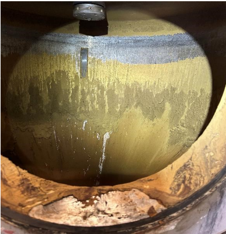
KUVA 1. Puhdistamaton spraykuivimen kammio (Andersson 2023.)
