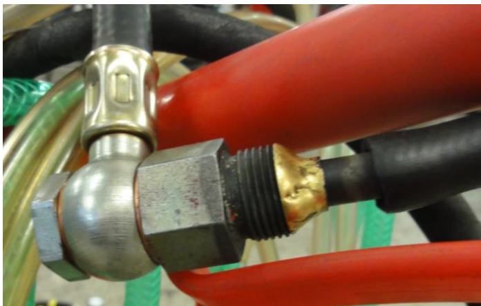
Kuva 14. Pienten Deutz -moottoreiden koestusta varten rakennettu, käyttöä nopeuttava Banjo-letkusovitin.
