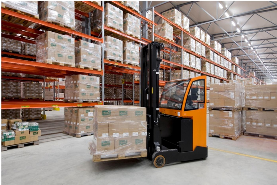
Kuvio 7. Roclan katettu työntömastotrukki kylmiin olosuhteisiin (Rocla Oy, n.d).
