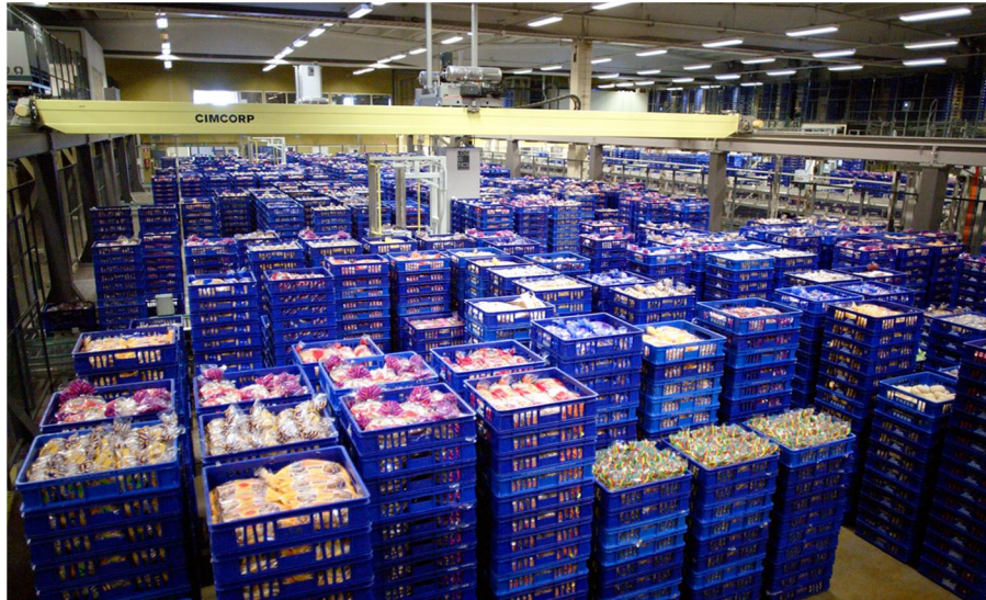
Kuvio 6. Cimcorp Oy:n automaattinen keräilyjärjestelmä (Ovaskainen, 2014).
