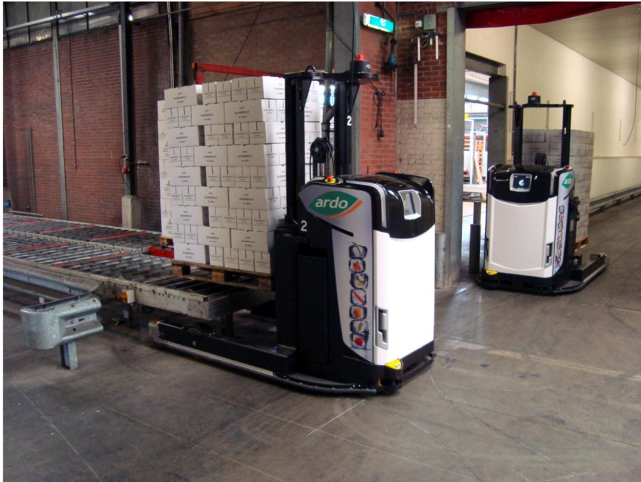
Kuvio 22. Automaattitrukit kuormalavojen siirrossa (Rocla Oy n.d).
