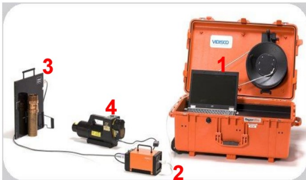
KUVA 5. DDA:n pääkomponentit. (DEKRA 2023)
