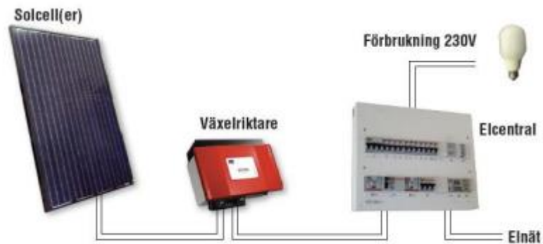
Figur 4. Illustration över hur ett solkraftverk är uppbyggt. (foi.se 2015).
