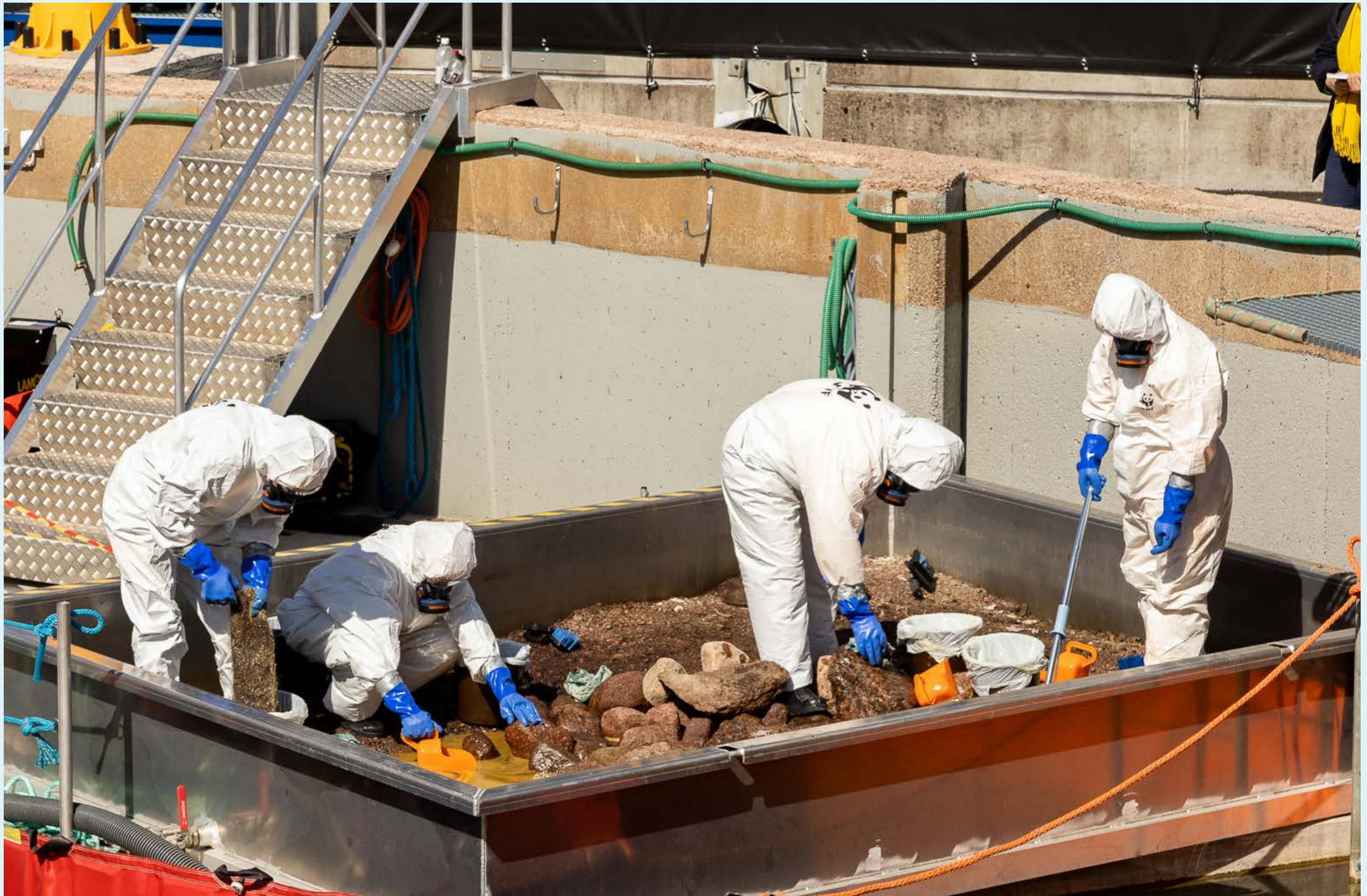
Kuva 10. Kotkassa sijaitseva öljyntorjunnan tutkimus- ja testiallas mahdollistaa öljynpuhdistuksen harjoittelun (Kuva: Mervi Koistinen)
