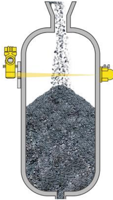
kuvio 15. Radiometrisen mittalaitteen mittausperiaate (Vega, N.d.)
