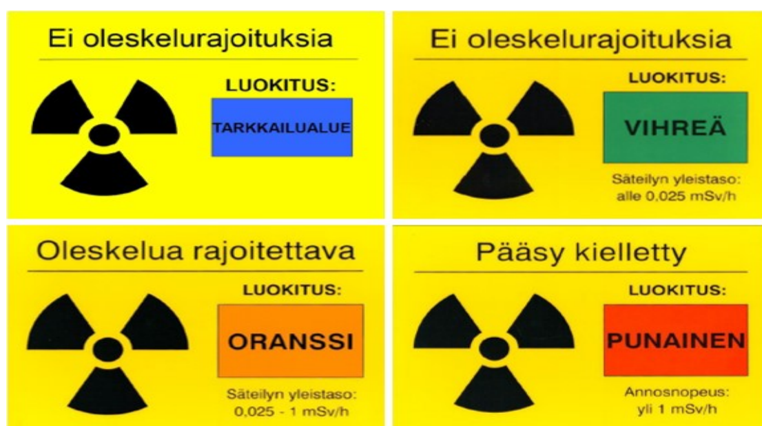
Kuva 6. Loviisan voimalaitoksen huoneluokituskyltit (Salminen 2021)
