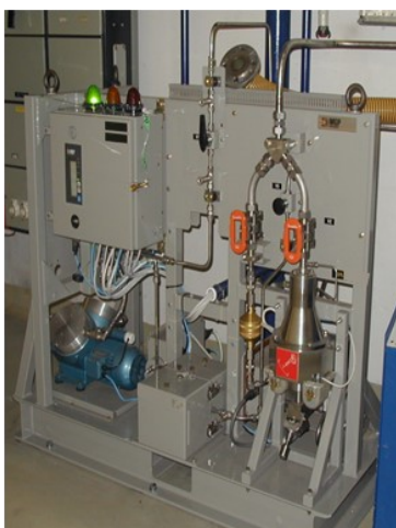
Kuva 8. Kiinteät säteilymittausjärjestelmät (mukaillen Fortum Power and Heat Oy 2004, 8–26)
