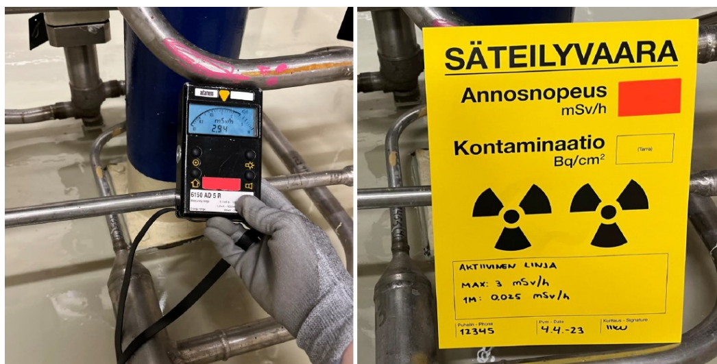
Kuva 17. Kuuman pisteen mittaus AutoMess 6150AD5R -annosnopeusmittarilla
