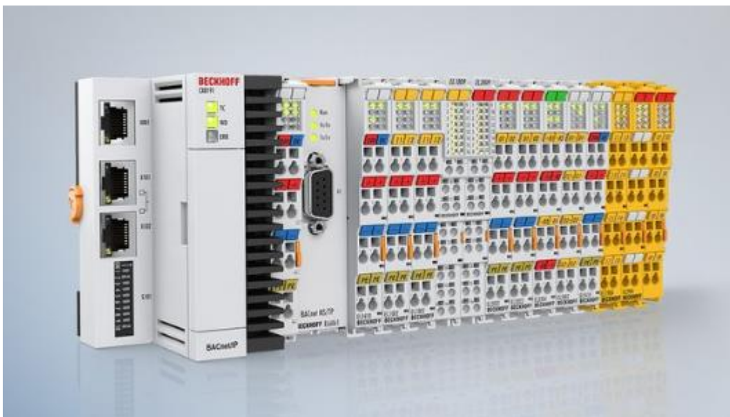
KUVA 6. Beckhoffin ohjelmoitavan logiikan (PLC) PC-pohjainen CX-sarjan CPU-yksikkö, johon lisätty mm. I/O- ja TwinSafe-turvakortteja. (Beckhoff Automation Oy n.d.)
