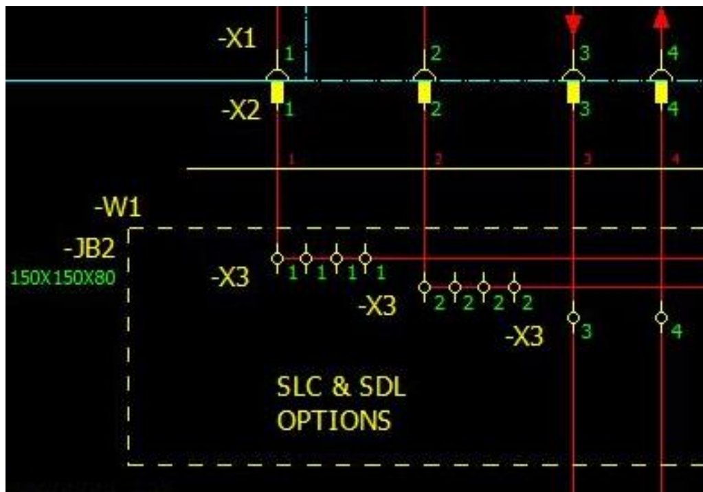
KUVA 18. Riviliitinkotelo JB2 ja turvalaitteiden riviliittimet.
