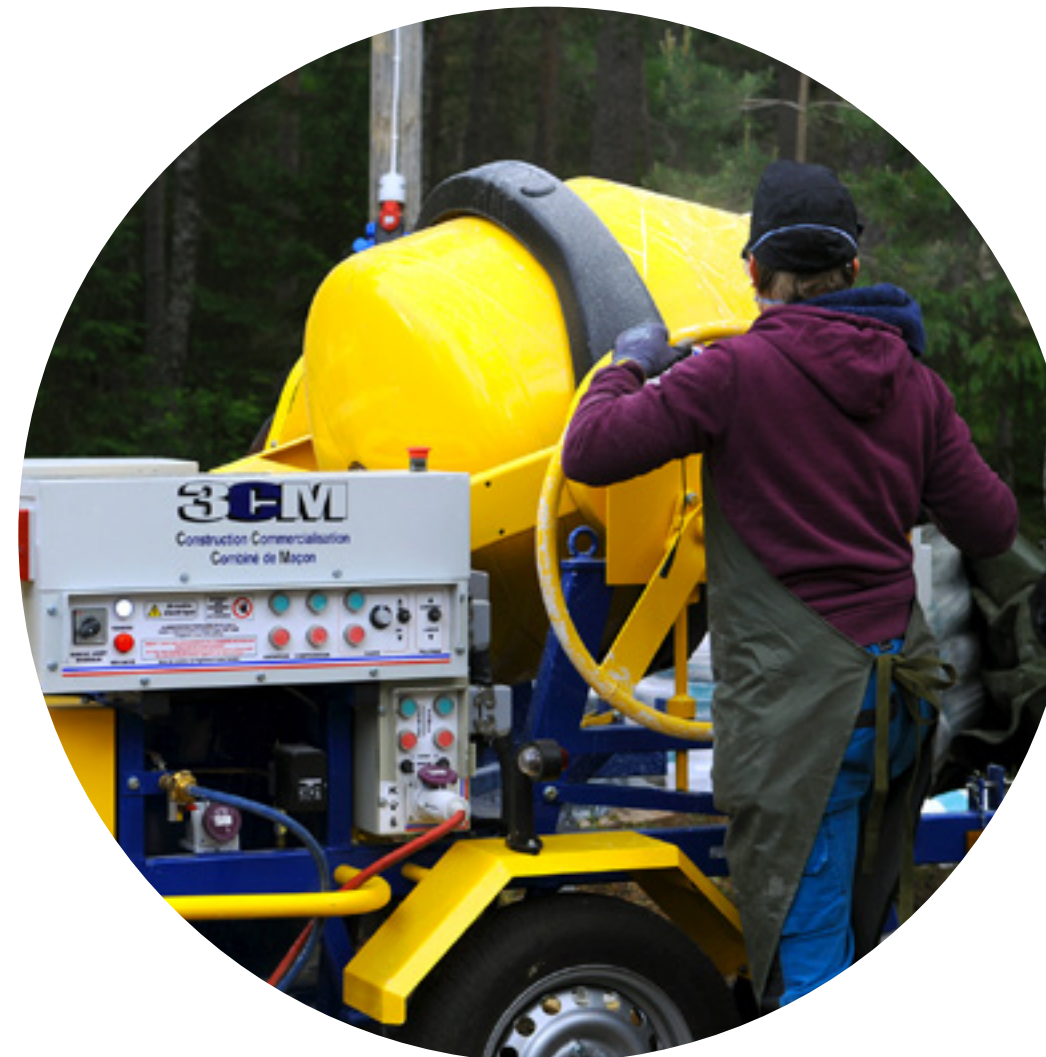
Markkinoilla on erikokoisia ruiskuvalulaitteita. Kuvassa olevan laitteen käyttämiseen tarvitaan kolme työntekijää.
