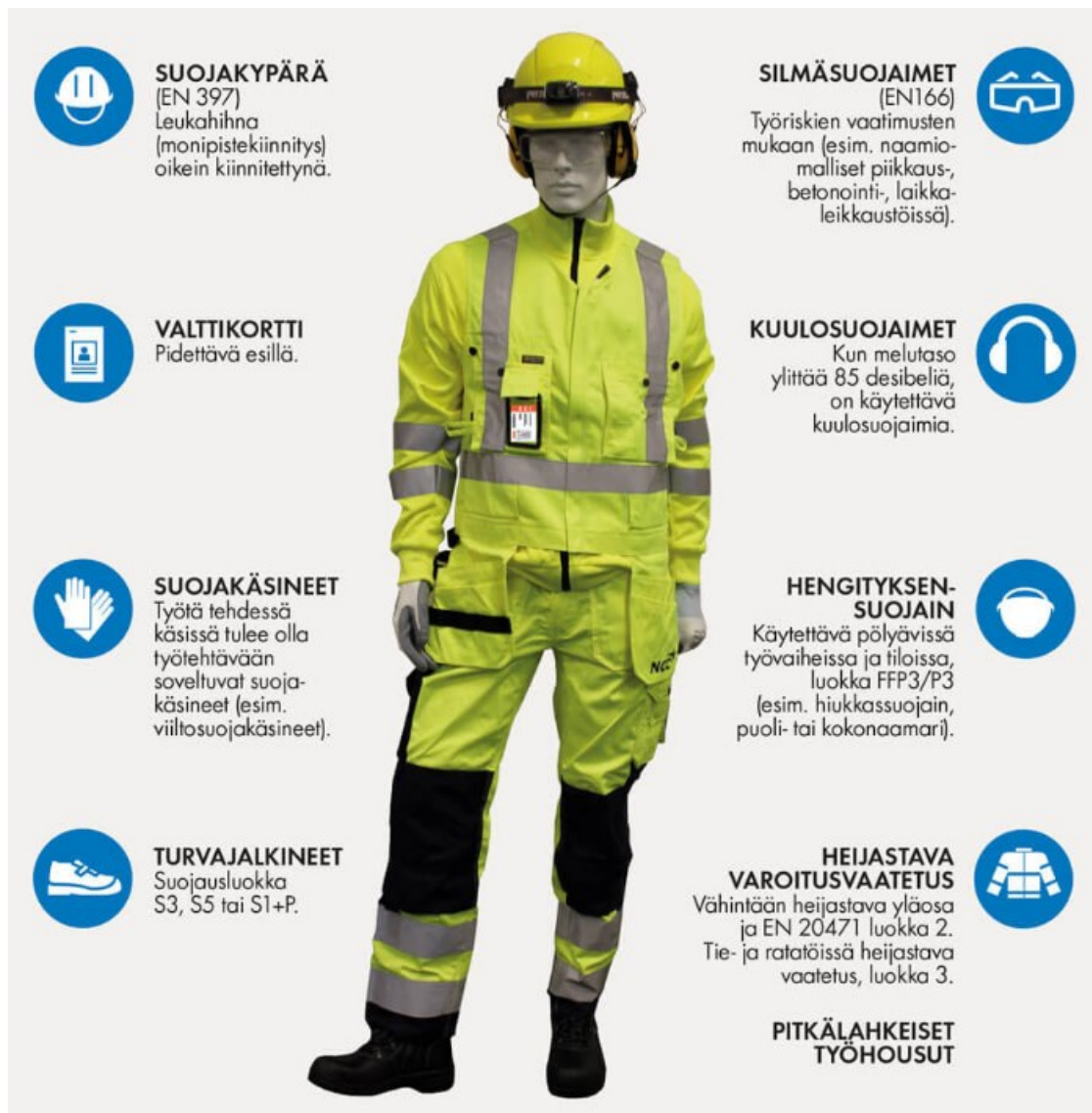
Kuva 6. NCC-työmaan opaste vaadittavista henkilösuojaimista (NCC Oy, 2023).
