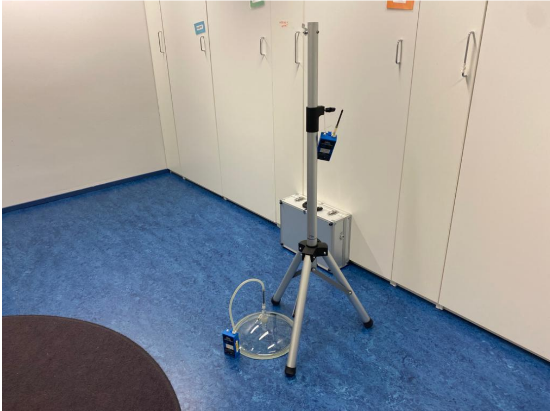
Kuva 8. Lattiapäällysteeseen kohdistettu kupunäyte sekä ilmanäyte, kuva Mikko Niskanen, IdeaStructura Oy
