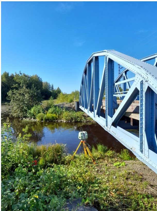
Kuva 2. Laserkeilaimella kartoitetaan haastavampia kohteita. Kuvassa laserkeilataan siltakohdetta elokuussa 2023 Imatra-Joensuu-välillä radan kehittämis- ja perusparannushankkeella.
