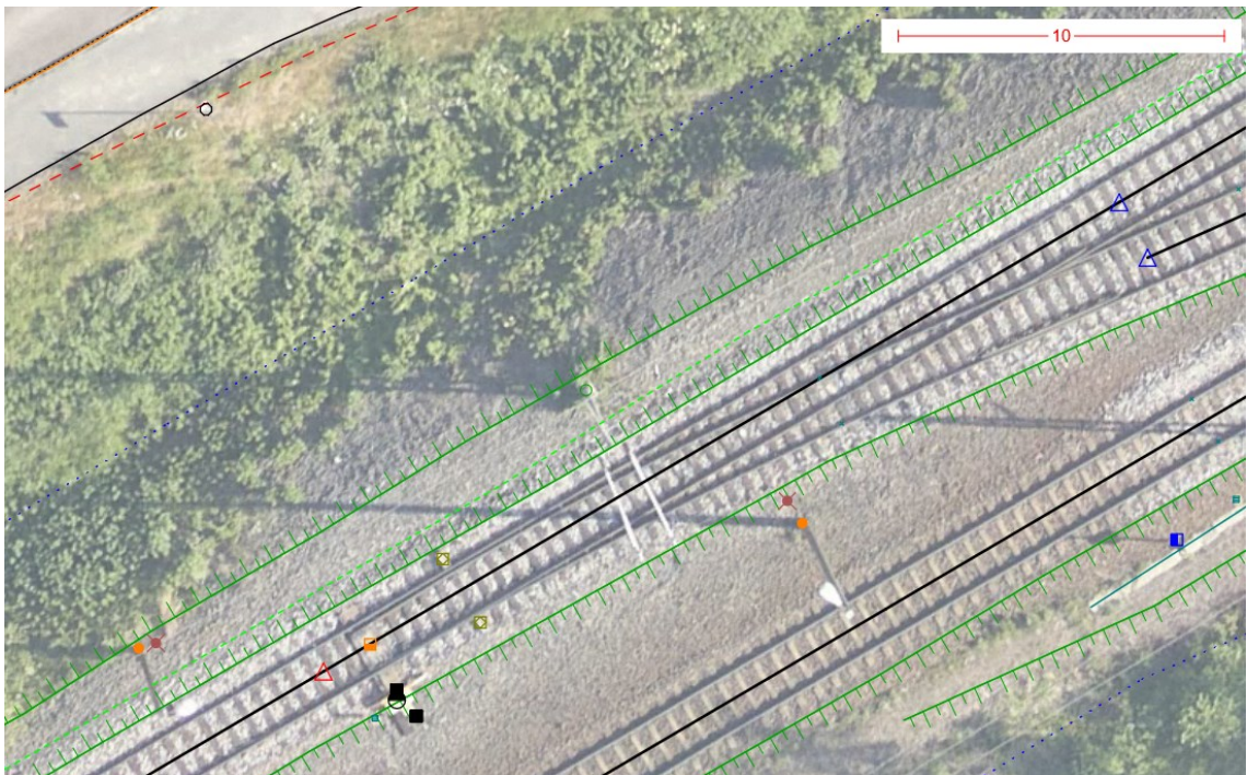
Kuva 4. Kartoitettuja raide- ja ratalaitteita, kuten vaihteen etujatkos (punainen kolmio), vaihteen takajatkos (sininen kolmio), tankokuoppa (oranssi neliö) ja vaihteen lämmittimen kytkinrasia (8).
