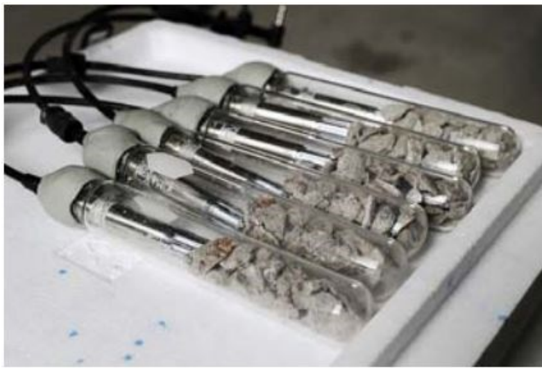
Kuva 8. Näytepalamittauksessa irrotetut näytepalat koeputkessa. [9.]
