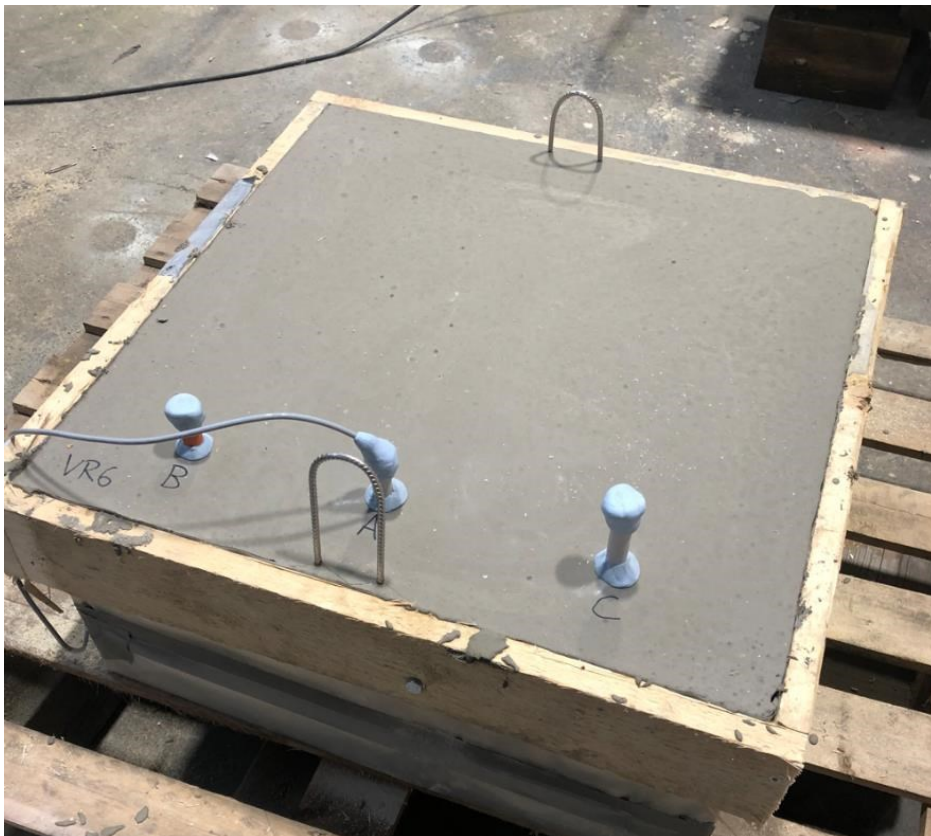
Kuva 6. VR6 rakenteen mittapisteet asennettuna. Valokuva: Sampsa Raevaara (2020).
