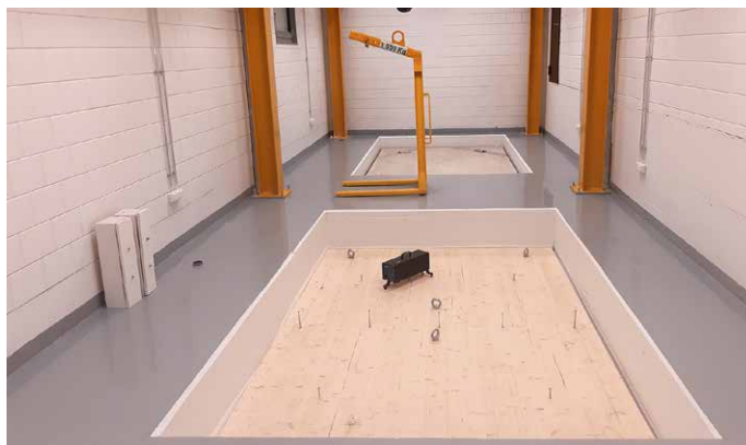
▲ Askelääneneristävyyttä mitataan asettamalla askeläänikoje tutkittavan lattian päälle. Valokuva on laboratorion yläkerrasta ja mittaus tehdään lattian alapuolisessa huoneessa.
