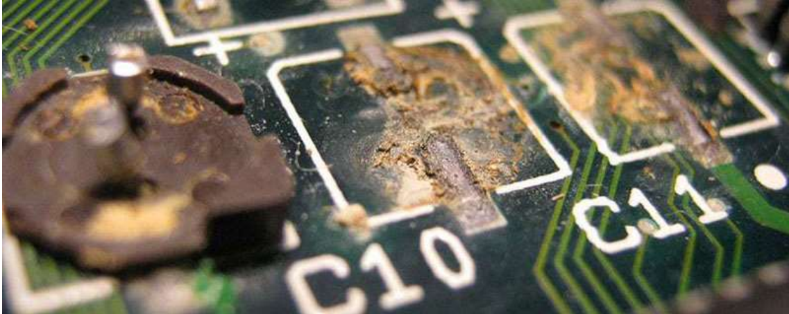
KUVA 1. Hapettuminen kuparisen piirilevyn pinnalla
