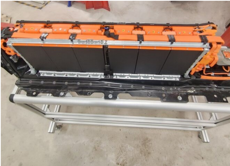
KUVA 14. Kennomodulit asennettuna akkuun
