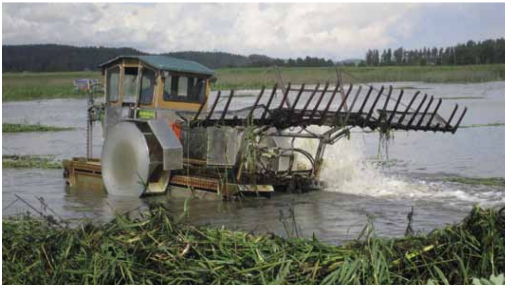
KUVA 10. Korjuussa käytettävä kelluva Truxor-leikkuulaite Kuva: Terhi Ajosenpää.
