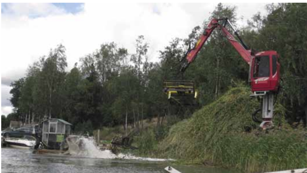
KUVA 12. Leikattu järviruoko nostetaan vedestä rannalle nosturilla. Kuva: Terhi Ajosnpää.
