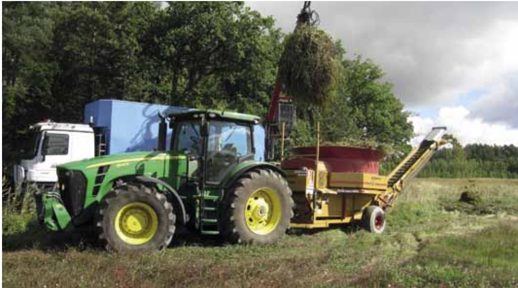
KUVA 13. Niitetyn järviruo'on silppuaminen Kuva: Terhi Ajosenpää.
