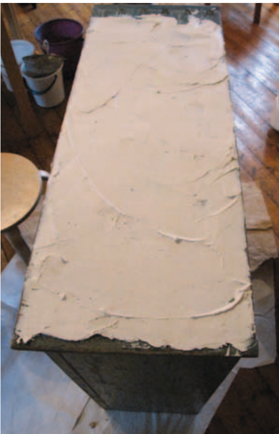
Maalinpoisto kalkilla ja saippuatahnalla.
