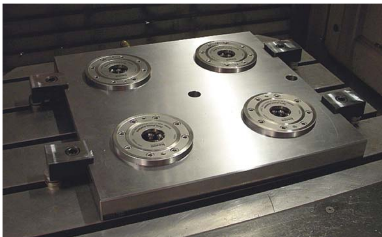
KUVA 17. Neljä sisäänrakennettua sylinteriä peruslevyssä.
