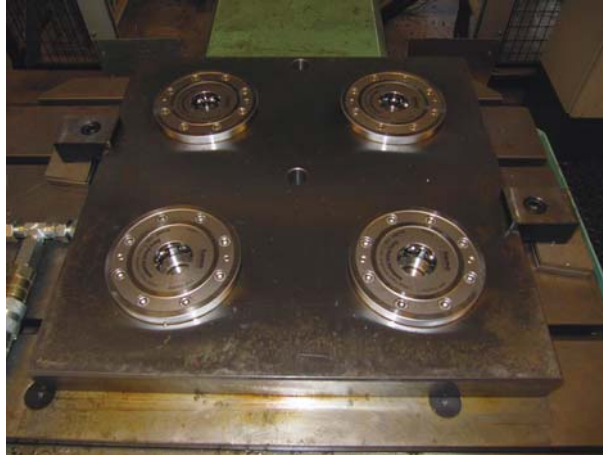
KUVA 79. Zero Point Systemsin aluslevy ja sen neljä elementtiä.
