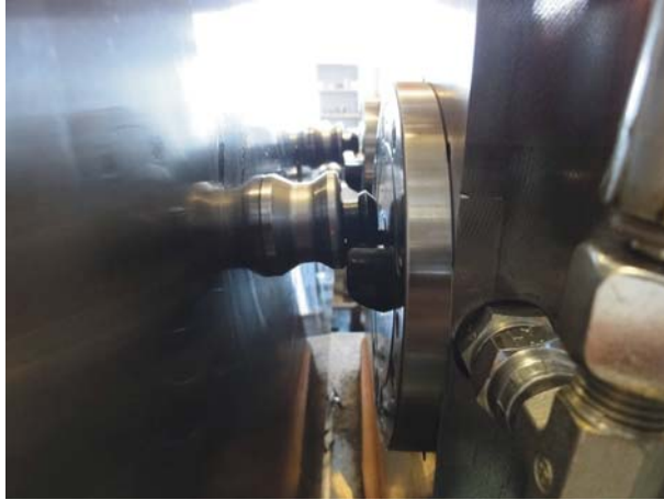
KUVA 30. Vetotapit ja koukkusylinteri. (Kuva: Pekka Törnqvist)
