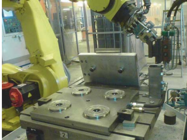
KUVA 7. Zero Point Systems:n 4-sylinterinen peruslevy sekä kiinnitinlevy. (Kuva: Sakari Koivunen)
