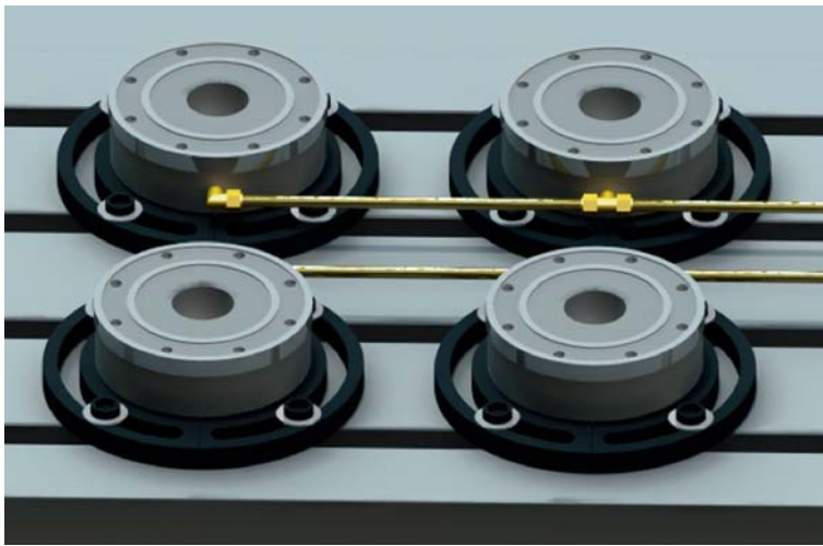
KUVA 19. Pinnalle asetettavia nollapistesylintereitä työstöpöytään kiinnitettynä.
