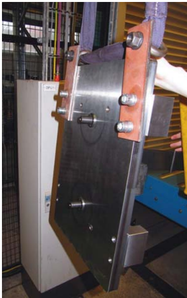
KUVA 94. Stark/V&B kiinnityslevy nosturissa.
