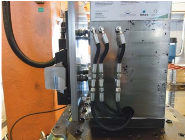
KUVA 31. Kiinnityslevy ladattuna vetotapit auki asennossa. (Kuva: Pekka Törnqvist)
