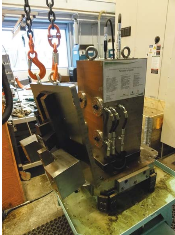
KUVA 29. Koukkutornin panostaminen nosturilla. (Kuva: Pekka Törnqvist)
