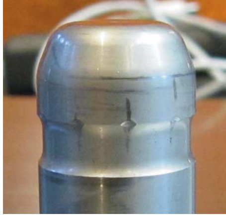
KUVA 84. Starkin tappi noin 100:n toiston jälkeen.
