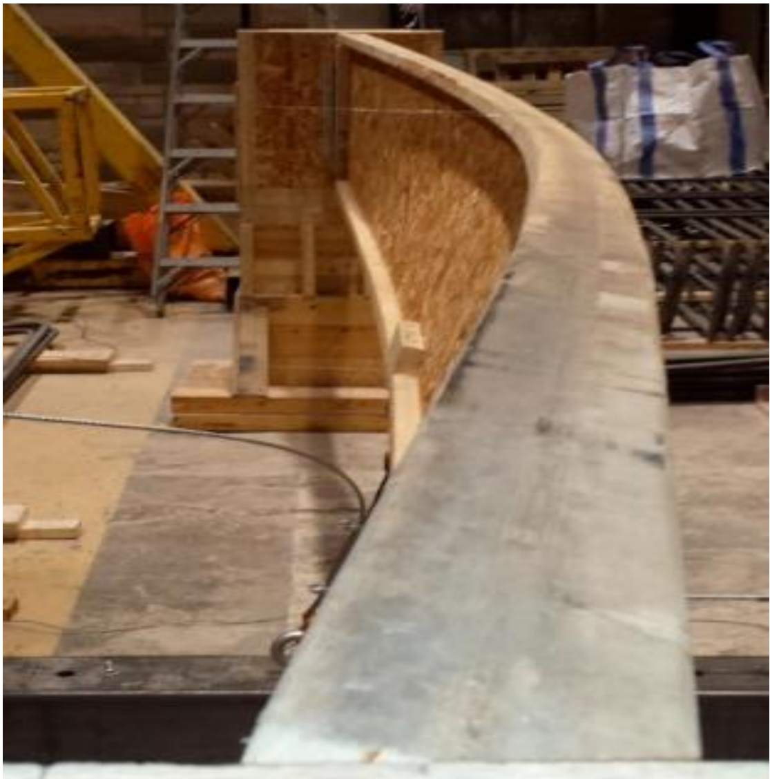
Kuva 25. Palkki, joka on kiepahdettu kuorman takia.
