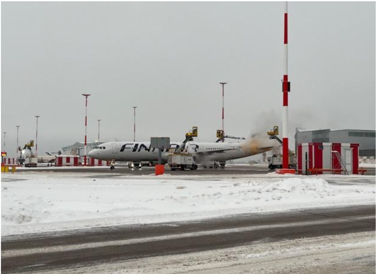
Kuva 3. Lentokoneen jäänpoisto asematasolla R8.
