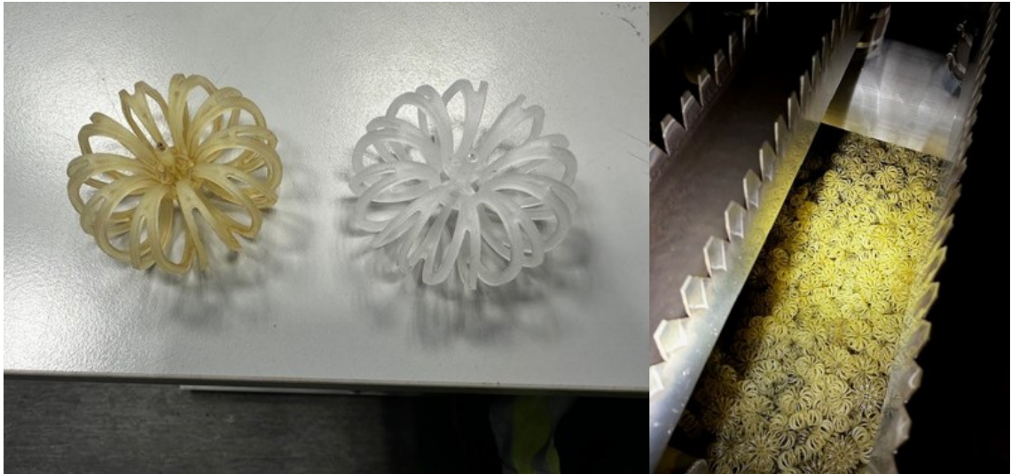
Kuva 12. Täytekappaleet kellastuvat ajan saatossa. Värjäntyminen ei kuitenkaan haittaa, vaan kunto testataan puristamalla.
