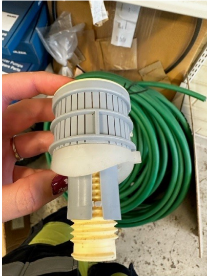
Kuva 27. Vesisuuttimia löytyy Kivenlahden lämpölaitoksen varastosta.
