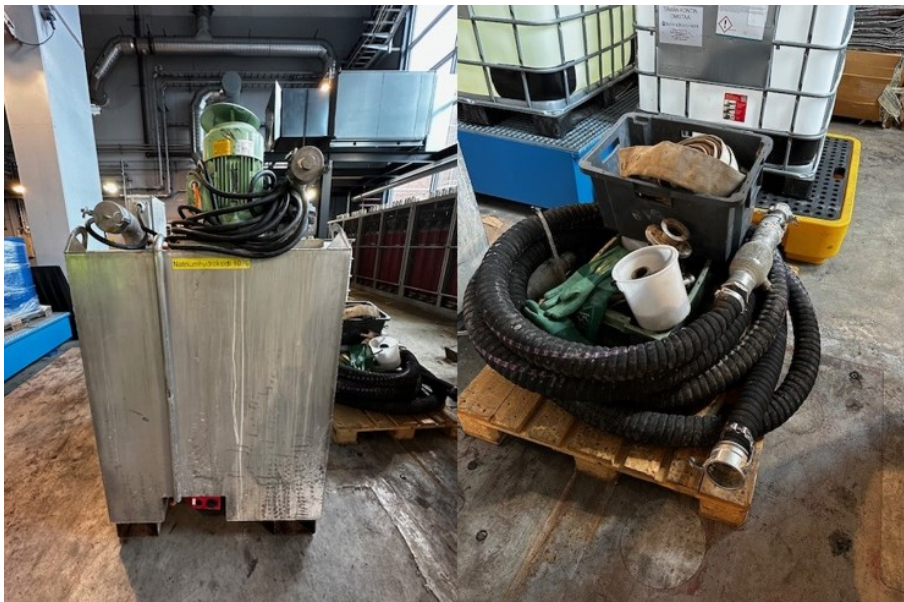
Kuva 51. Suomenojan voimalaitoksen lämmönvaihtimien pesuun tarkoitettu pesukone.
