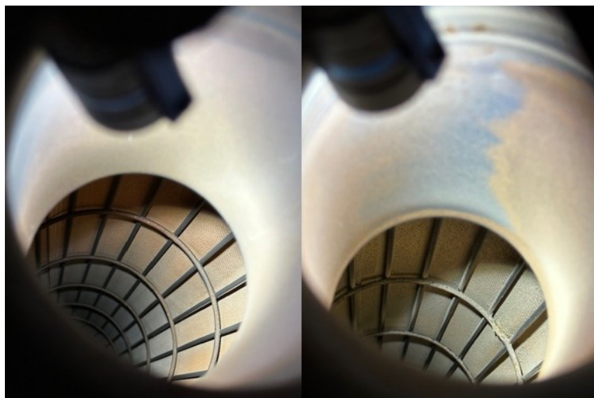
Kuva 48. Vasemmalla ehjä sukka, oikealla rikkinäinen sukka.
