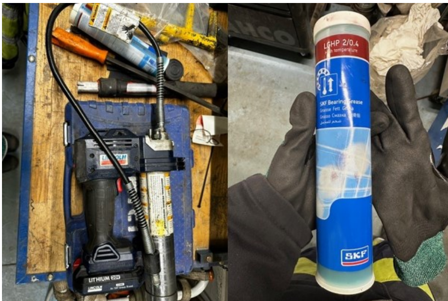
Kuva 32. Rasvaukset tehdään annostelijaprässillä.
