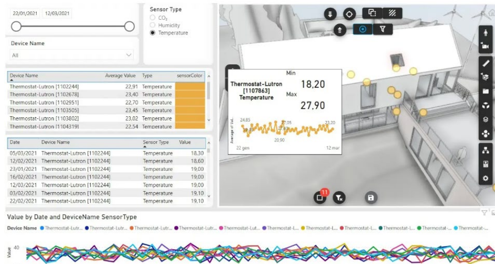
Kuva 10. VCAD-ohjelman avulla voidaan esittää esimerkiksi sensoreiden dataa [13].
