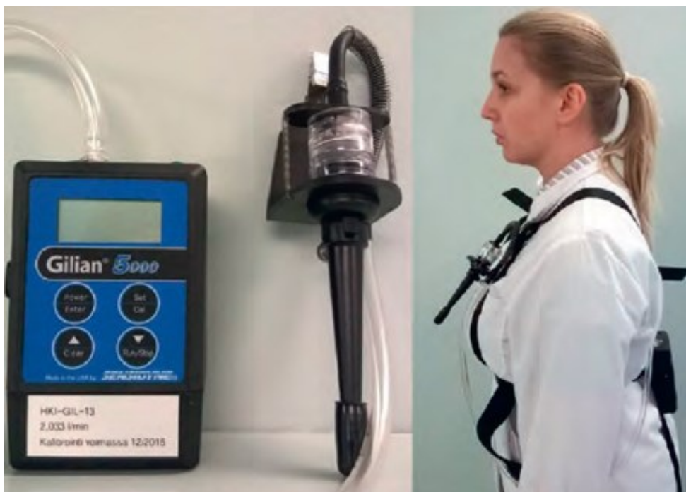
Kuva 5. Hengitysvyöhykkeelle sijoitettava alveolijakoisen pölyn näytteenottoon käytettävä keräin ja pumppu [6, s. 162].
