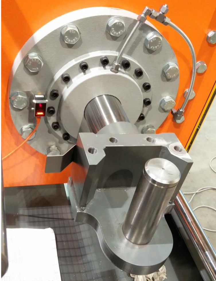
Kuva 12: Hydraulinen sylinteri, sen paikoitukseen tarkoitettu laseretäisyysanturi, sekä sylinteriin kiinnitettävä työkalu johon etäisyysanturin teräksinen taustalevy on asennettu
