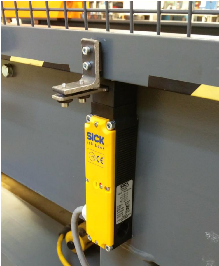
Kuva 15: Testilaitteen takaosan turvaoven elektronisesti lukitseva turvalukko
