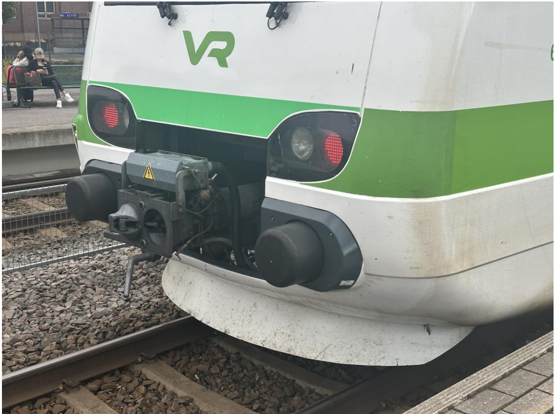
Kuva 2: SM4 lähijunan automaattikytkin
