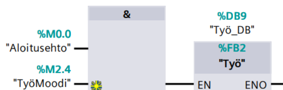
Kuva 26: Yksinkertainen AND logiikkaoperaatio, jolla asetetaan "Työ"-ohjelmalohkon toimintaehto.
