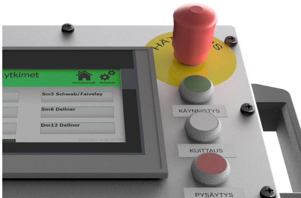
Kuva 14: Käyttöliittymän yhteyteen asennettu hätä-seis painike
