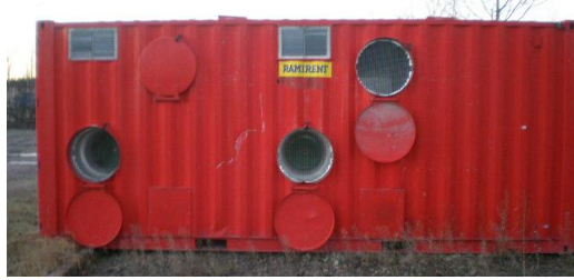
Kuva 9. 620 kW:n öljykäyttöinen lämpöpuhallin.
